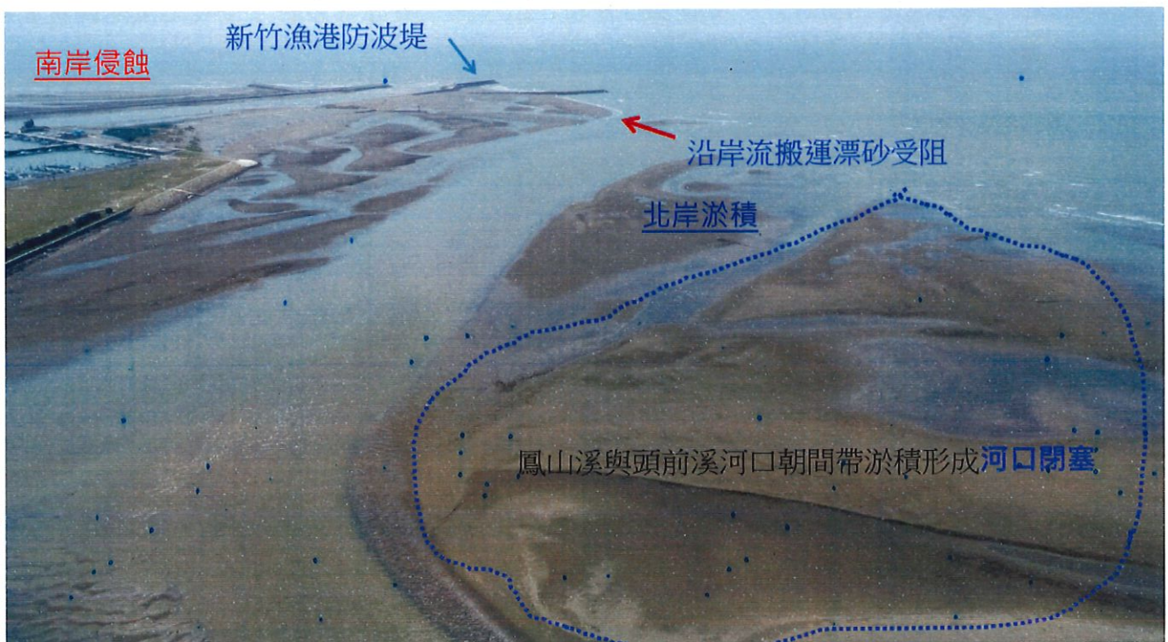
圖 3 鳳山溪與頭前溪河口淤沙因突堤效應形成閉塞
