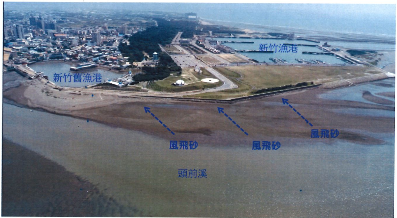
圖 4 漁港北側淤積形成風飛砂
