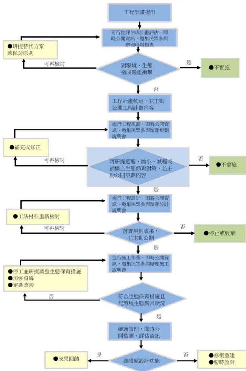
圖 3.1 公共工程生態檢核作業流程
