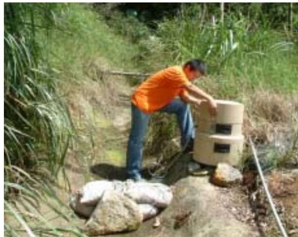
圖 5-16 工作人員於竹子湖樣區（圖左側山坡）下方既有噴漿 U 型溝架設自動採樣器實景。
