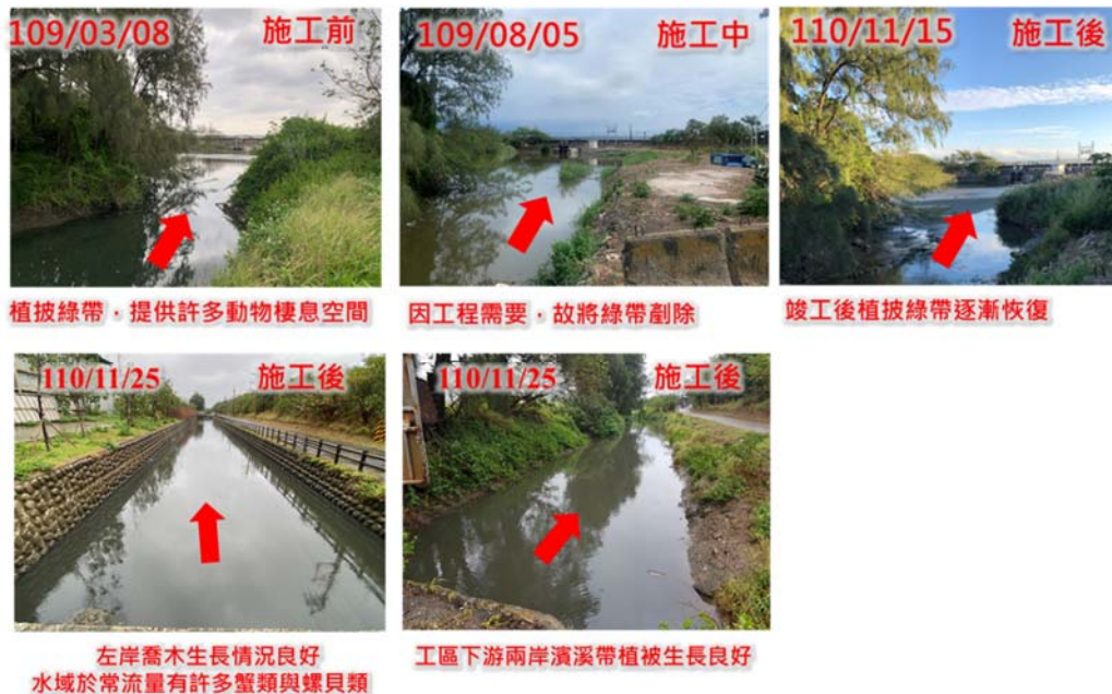
圖 3 港北金城橋排水幹線護岸新建應急工程(0K+090-0K+302)棲地影像監測圖
