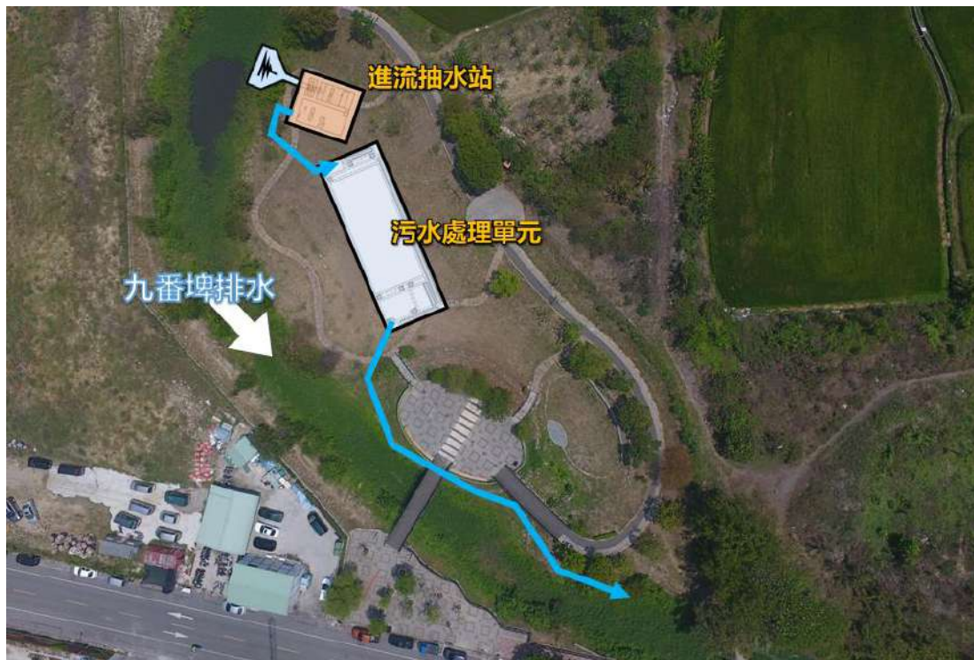
圖 2.1-14 九番埤排水水質淨化場截流溝及進流抽水站平面示意圖
