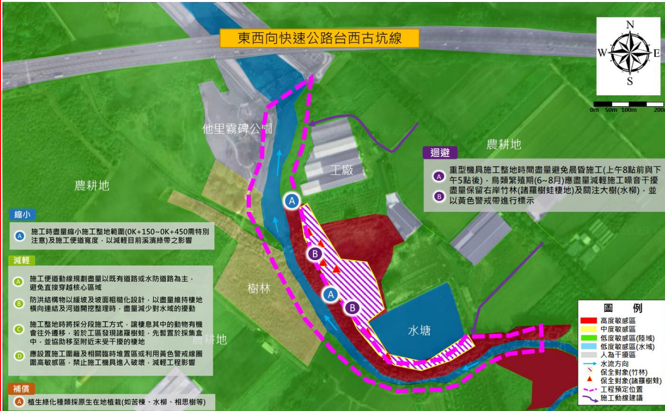
水利署第五河川局_崙子溪他里霧堤段改善工程_生態保育措施施作位置示意圖
