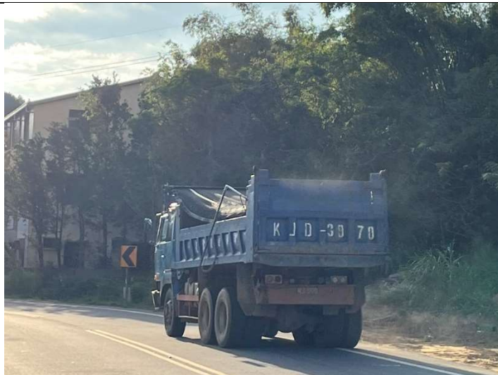
運輸土方車輛以防塵布覆蓋
