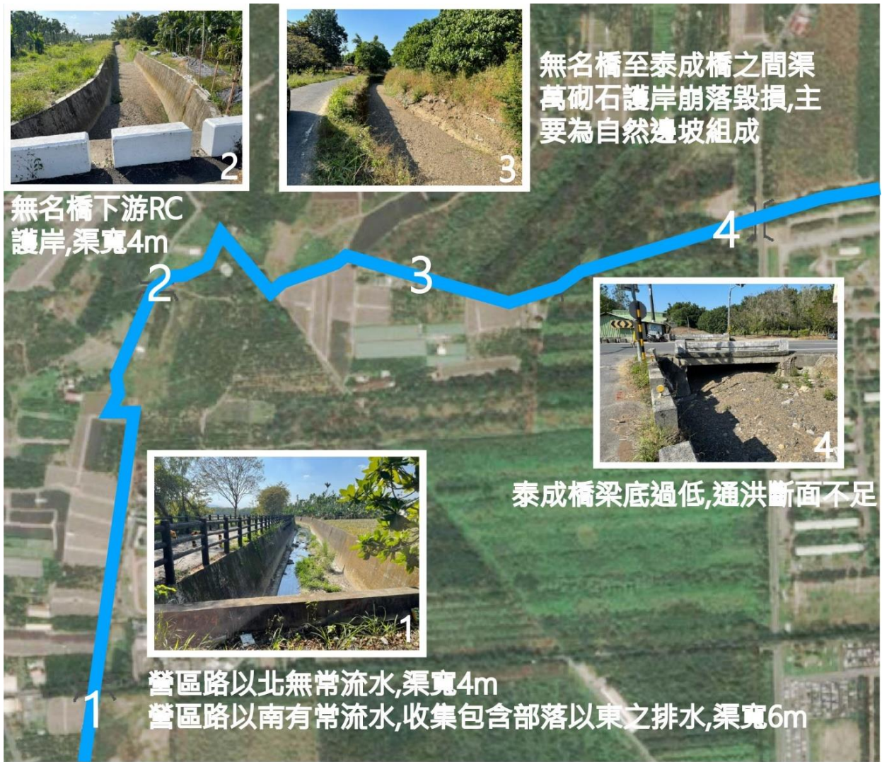
圖 3-123 萬巒鄉吾拉魯茲部落後方易淹水區規劃檢討工程環境現況圖
