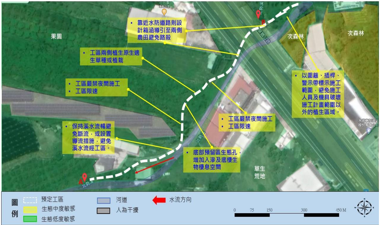
圖 3-11 台一線 437K+700 處易淹水區排水改善工程生態檢核補充建議圖
