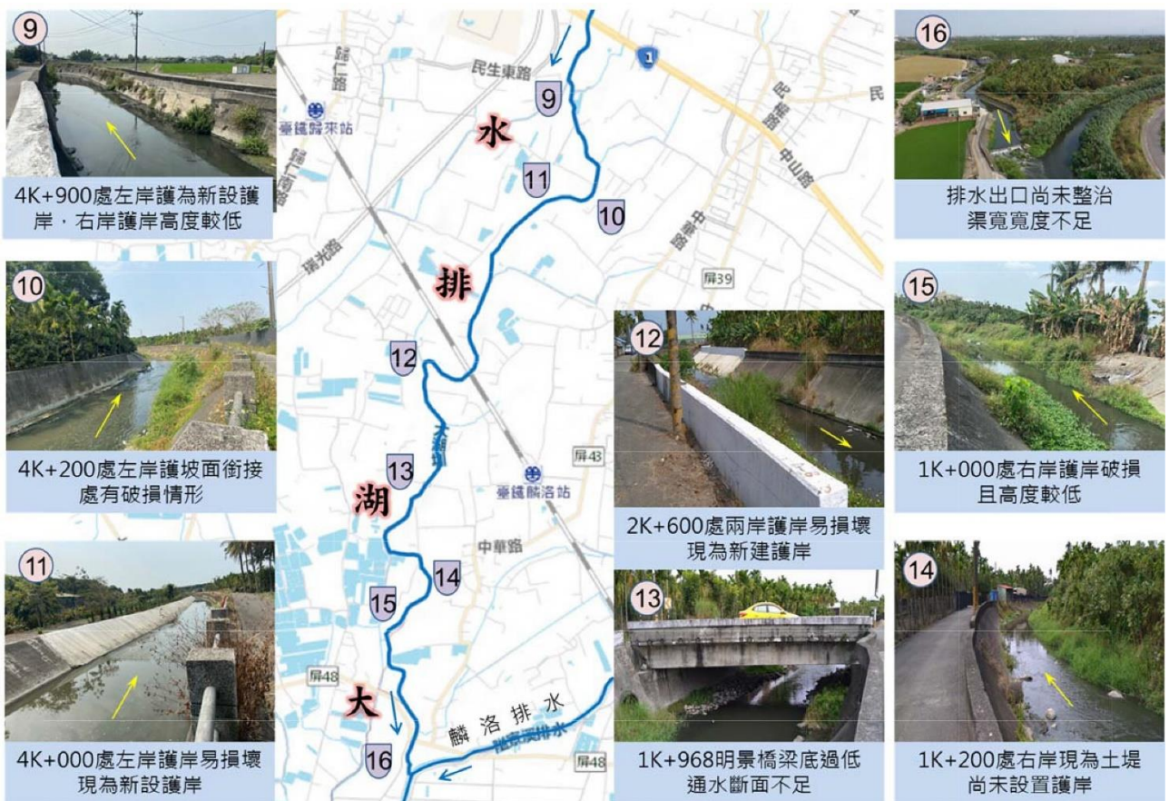
圖 3-126 麟洛排水系統-長治交流道地區排水改善規劃下游環境現況圖
